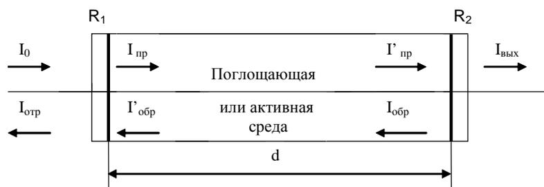
Рис. 4. Интерферометр Фабри-Перо, заполненный поглощающей или активной средой
